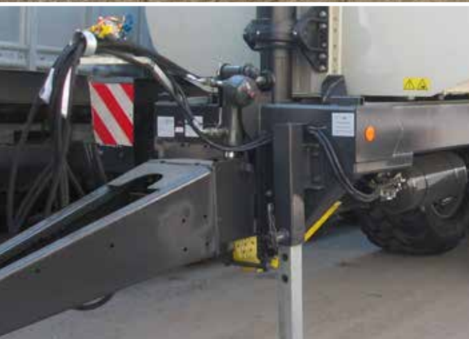
Hydraulisch gefederte und höhenverstellbare Deichsel
