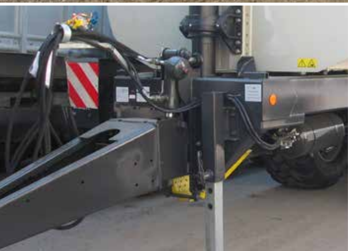
Fèche à suspension hydraulique réglable en hauteur
