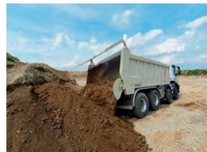
Steht sicher auch in unebenem Gelände und lädt schnell und vollständig ab: LKW mit Abschiebeaufbau.
